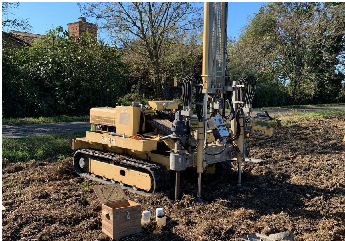
Figura 9. Esecuzione della CPTU01.
