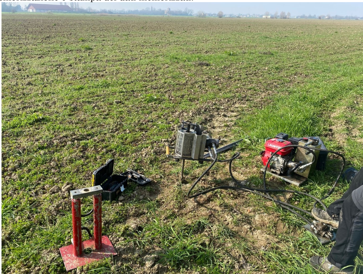
Figura 10. Esecuzione della DPM 09.
